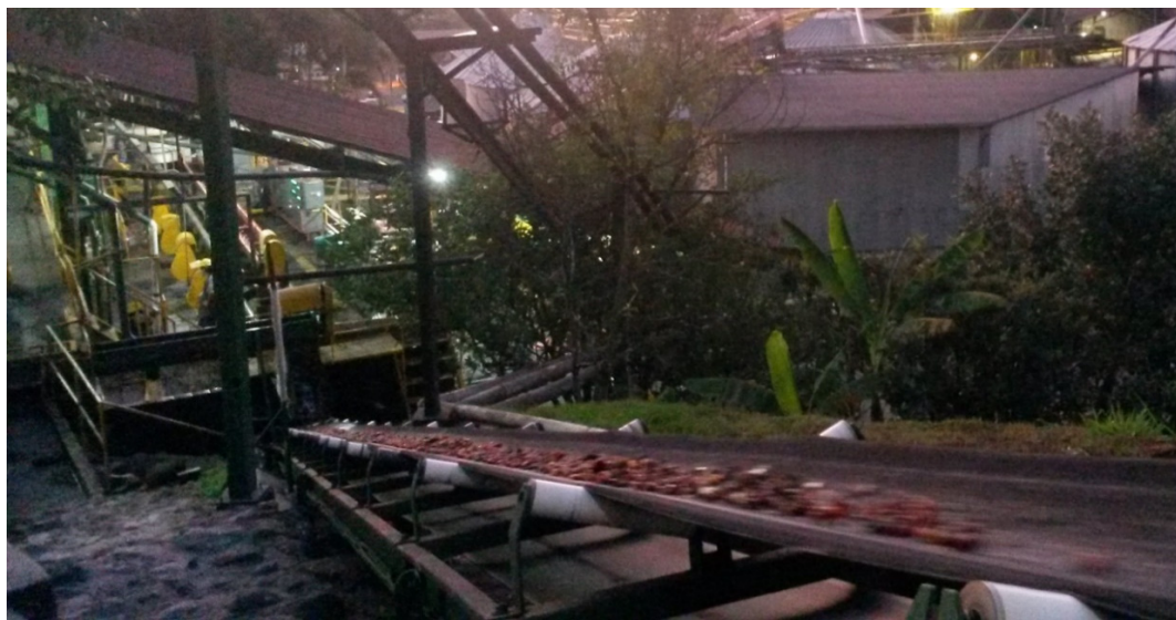
Figura 8. 2. Línea de descarga a la salida del equipo de despulpado del beneficio de CoopeTarrazú R.L., de donde se tomaron las muestras de broza correspondientes a la primera zona geográfica de estudio
