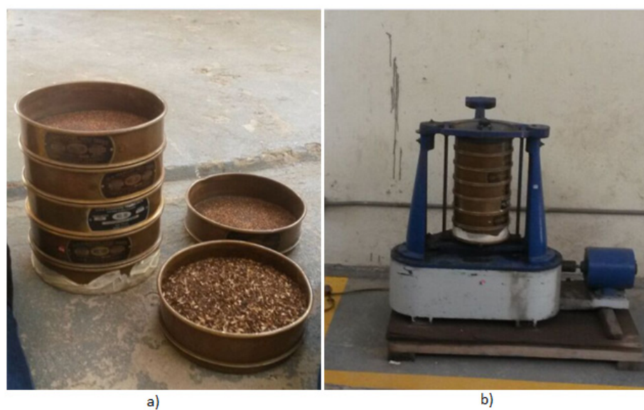
Figura 8. 7. a) Material tamizado; b) Tamizador del Laboratorio de Ingeniería Química
