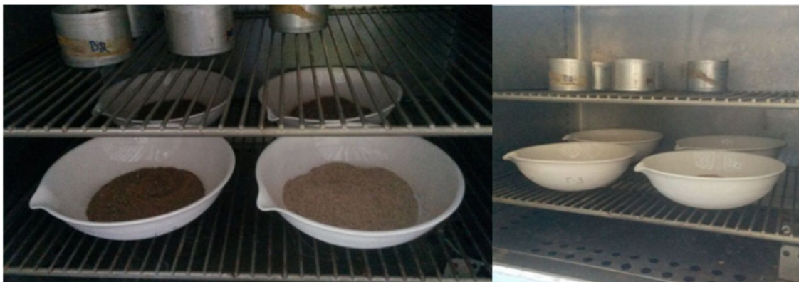
Figura 8. 10. Crisoles de porcelana en horno para determinación de humedad y porcentaje de sólidos totales en muestras de broza de café y madera
