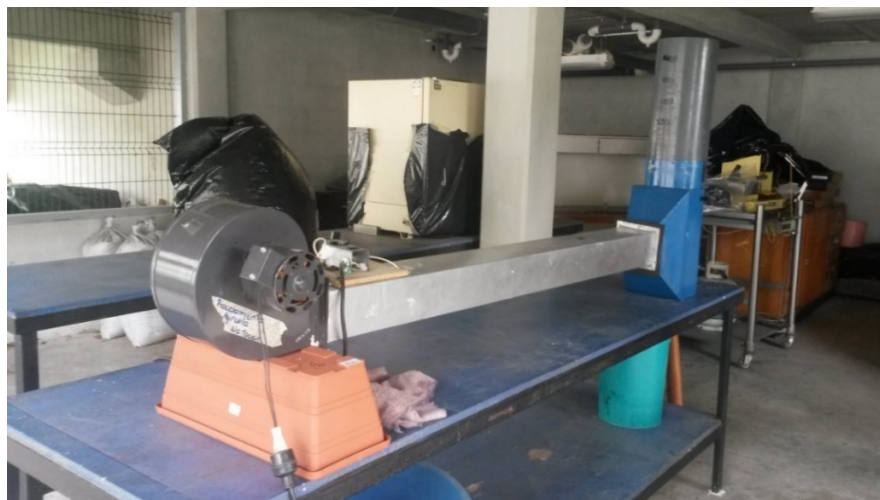
Figura 8. 3. Secador experimental del Centro para Investigaciones en Granos y Semillas (CIGRAS) de la Universidad de Costa Rica
