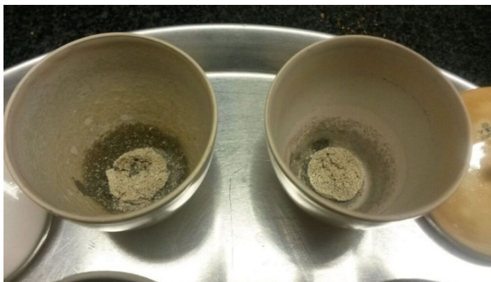
Figura 8. 13. Cenizas de chips de madera obtenidas al final del proceso de oxidación seca
