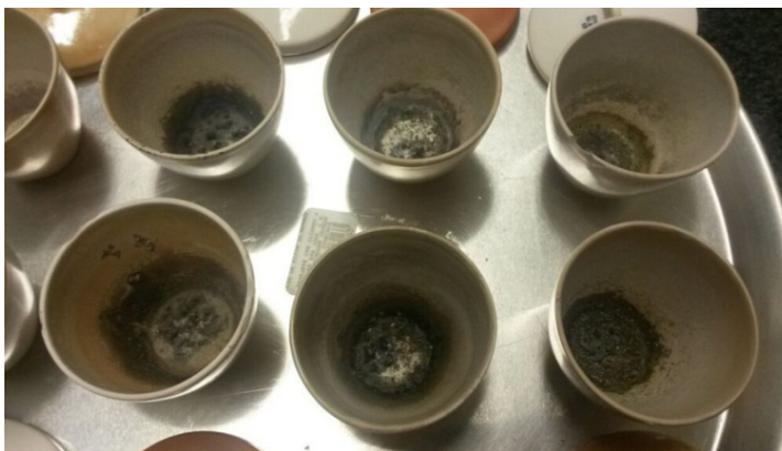
Figura 8. 14. Residuos de la determinación de materias volátiles mediante calentamiento a 950^\circ\text{C}
