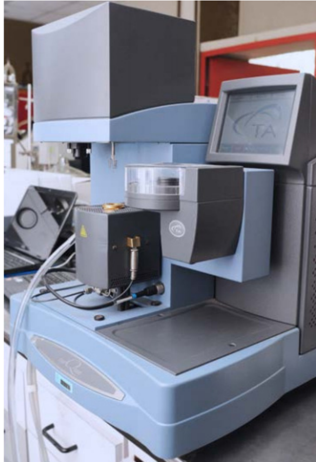
Figura 8. 16. Equipo para análisis termogravimétrico TGA Q5000 IR (Laboratorio Nacional de Materiales y Modelos Estructurales, 2017)
