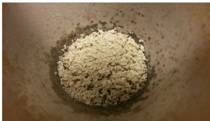
Figura 8. 12. Cenizas de broza de café obtenidas al final del proceso de oxidación seca
