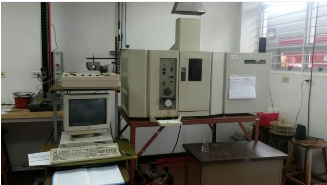
Figura 8. 15. Espectroscopio de emisión atómica con plasma (ICP) del Centro de Electroquímica y Energía Química (CELEQ)
