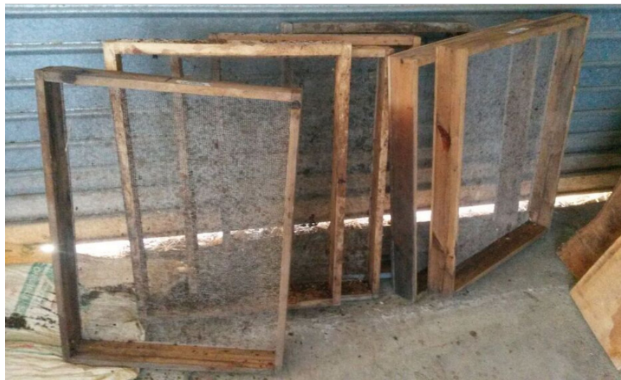
Figura 8. 5. Bandejas con cedazo utilizadas para el secado de broza de café en el Centro de Investigación en Innovación Forestal (CIF) del Instituto Tecnológico de Costa Rica
