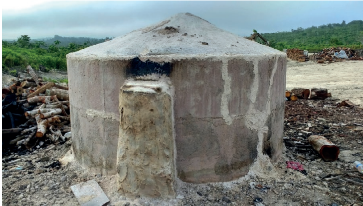
Figura 18. Estructura de un horno media naranja modificado, ubicado en el ejido Río Escondido, Quintana Roo.
