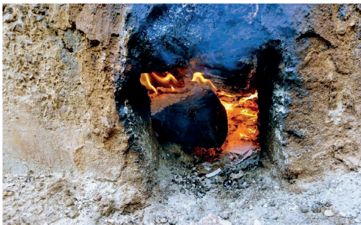
Figura 20. Proceso de carbonización finalizado, se observa una tonalidad azul al momento de salir por el respiradero inferior.
