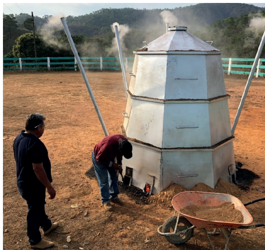
Figura 22. Seguimiento al proceso de quema en el horno metálico INIFAP-CEVAG.
