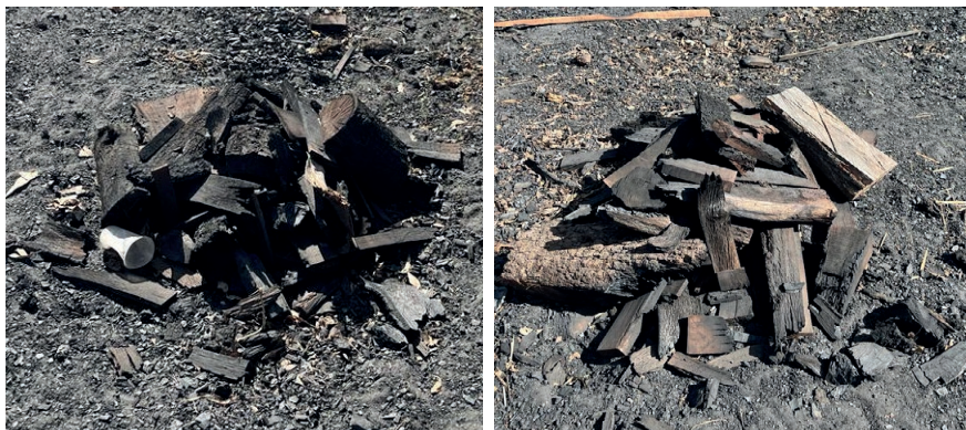
Figura 3. Leña sin quemar que se produce cuando no se puede controlar de forma adecuada el proceso de carbonización en los hornos tipo montículo.
