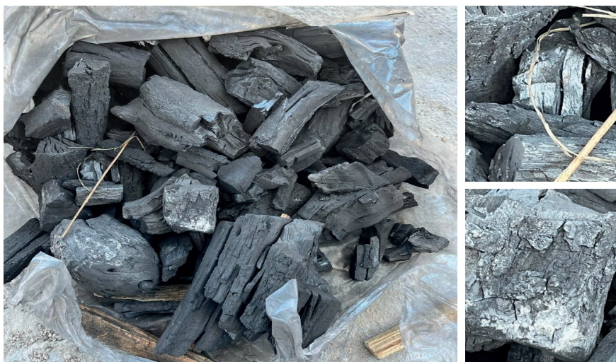
Figura 4. Bolsa típica de carbón vegetal producido en un horno tipo montículo. Se observan restos de acículas, ceniza y material sin carbonizar apropiadamente.
