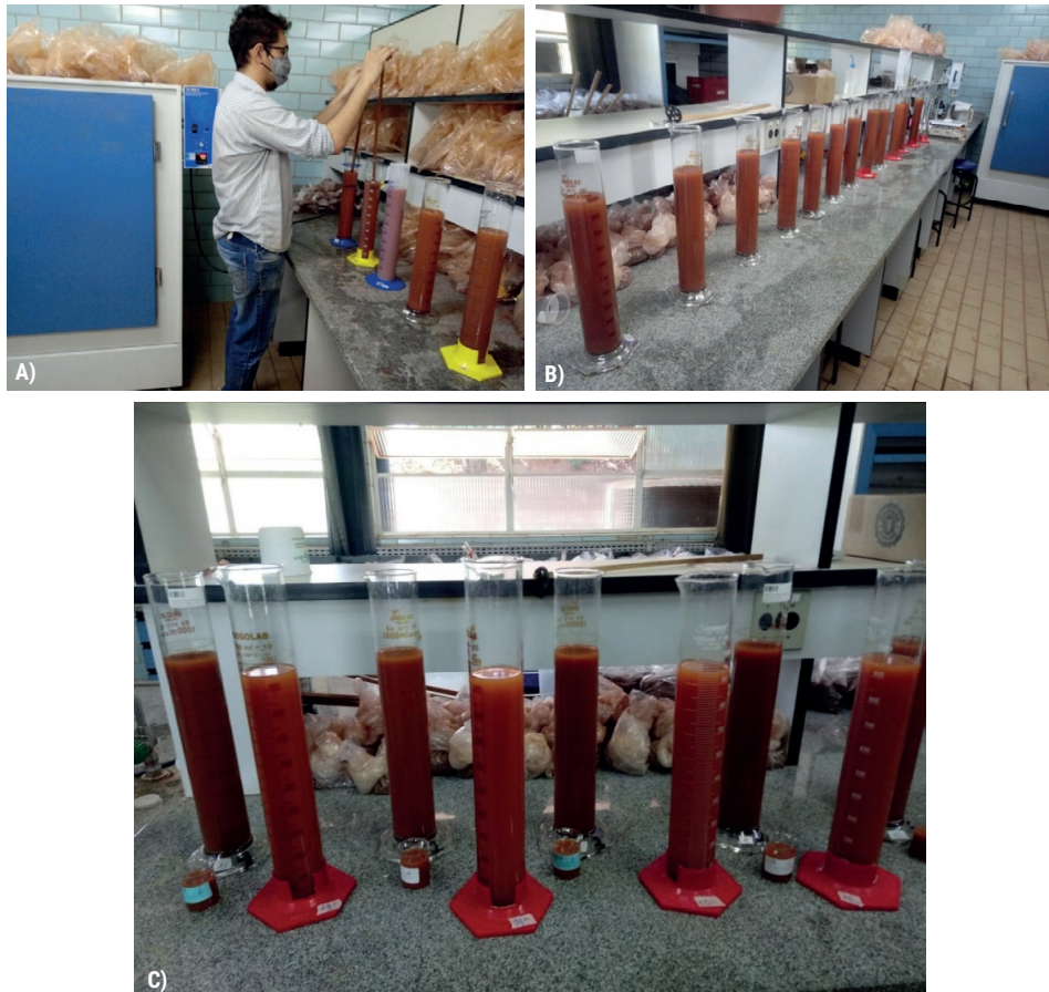
Figura 6. (A) Agitação manual das amostras, utilizando bastão de madeira, 30 agitações com movimento constante; (B) Amostras de Granulometria em descanso de 3 horas e (C) Amostras de Argila Dispersa e Granulometria.
