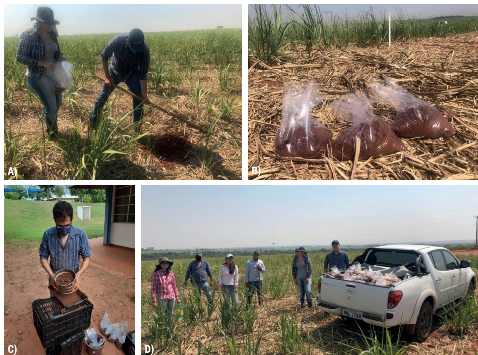
Figura 4. (A) Coleta manual das amostras de solo nas três camadas, em todas as parcelas estudadas; (B) Amostras deformadas do tipo torrão, nas três profundidades estudadas (0-0,10; 0,10-0,20 e 0,20-0,40 m); (C) Equipe de trabalho reunida após a primeira coleta de solo na área experimental; e (D) Peneiramento das amostras (peneiras de 2; 4 e 6 mm) e separação do solo para as posteriores análises.
