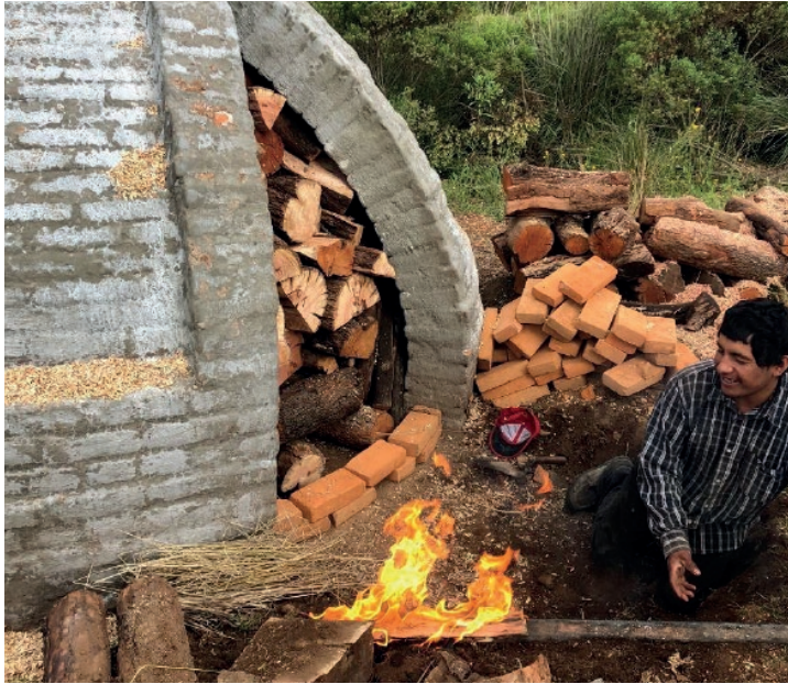
Figura 15. Encendido del horno por la parte baja y con la ayuda de una antorcha de extensión. Fuente: INIFAP, 2020.
