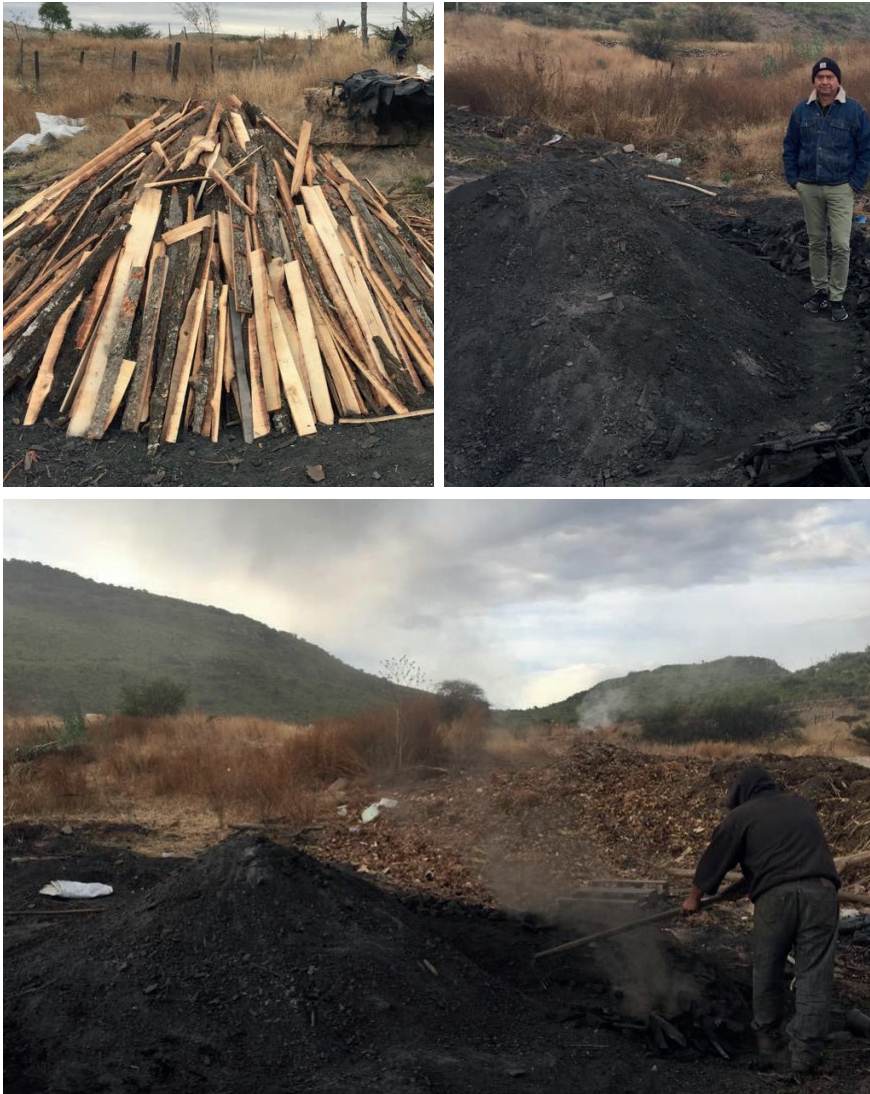
Figura 2. Atención de un horno tipo montículo en la Vinata, Durango, Dgo.
