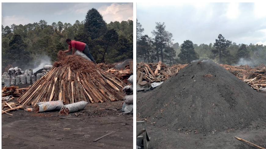
Figura 1. Preparación de un horno de montículo o parva, ubicado en el municipio de Pueblo Nuevo, Durango.
