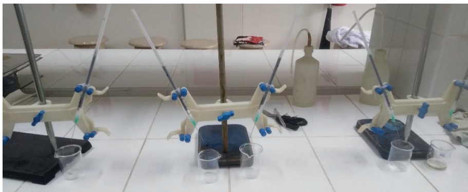
Figura 3. Determinación de adsorción de azul de metileno en el carbón activado.
