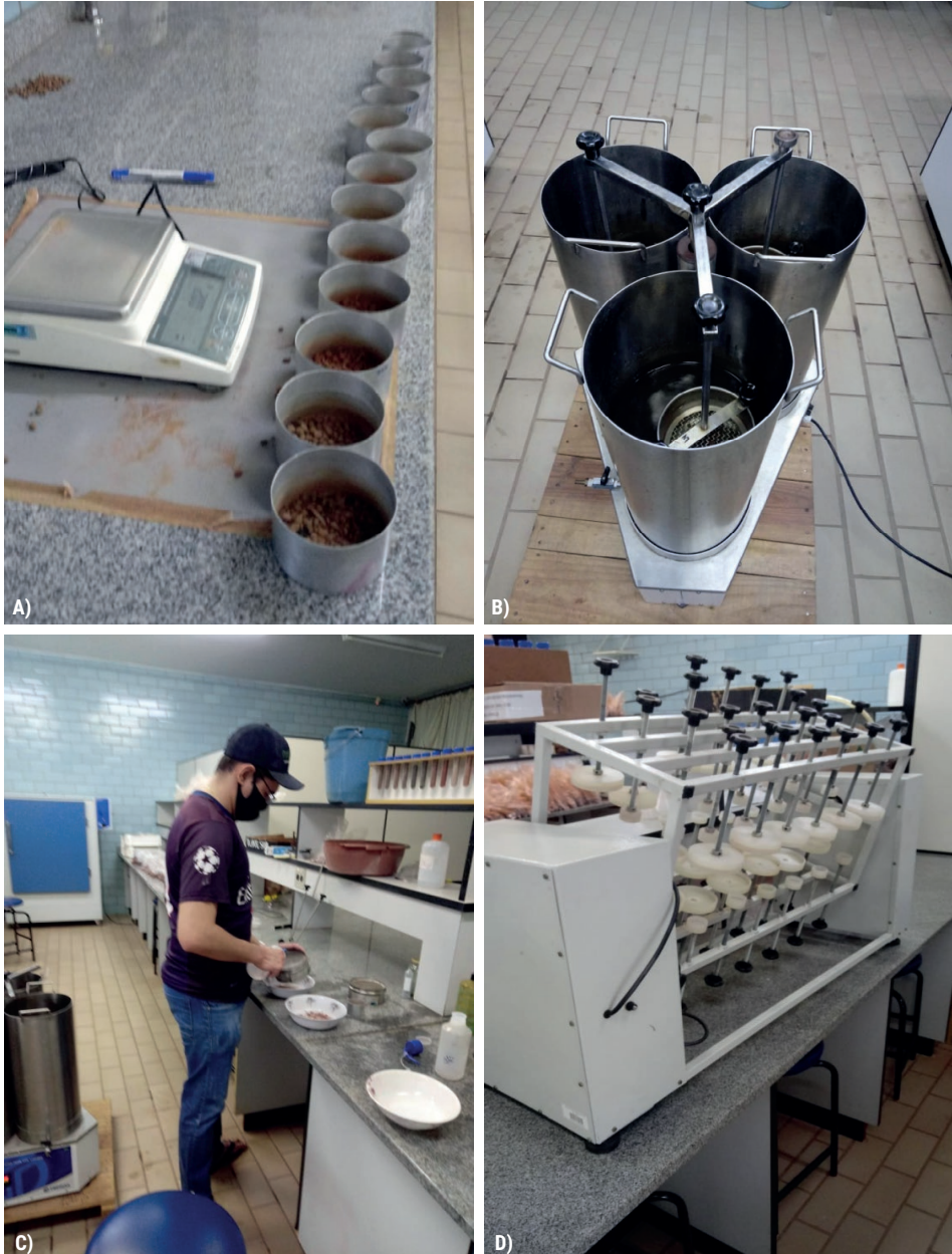
Figura 5. (A) Pesagem de 20 g de solo para análise de agregação (distribuição por classes de tamanho e estabilidade de agregados); (B) Agitador vertical (mesa modelo TE3300) com peneiramen-
