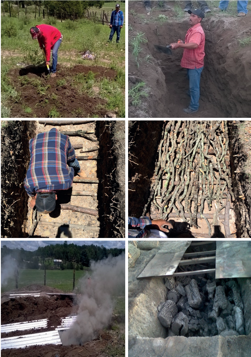
Figura 7. Estructura de un horno tipo fosa con tapa metálica proceso de construcción, apilado de la leña, proceso de carbonización y extracción del carbón.
